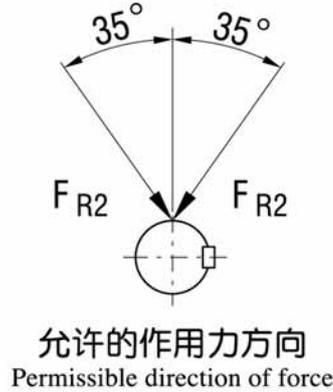
允许的附加径向力Fr2 (kN), 作用于输出轴端中部\*\*
