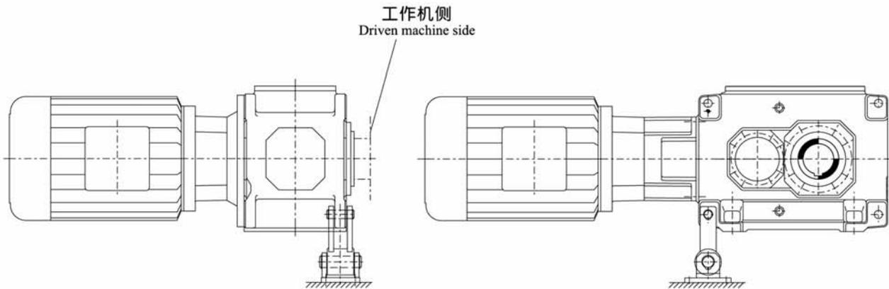
扭力臂应在靠工作机一侧，如果减速箱带有风扇，扭力臂就安装在电扇另侧。
